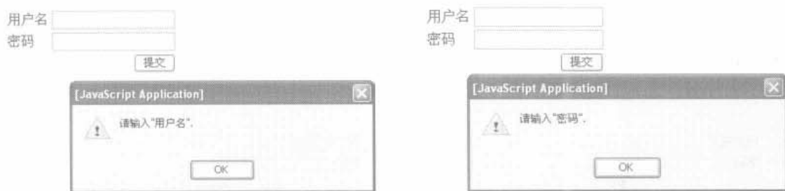
图 9-5 校验用户输入方法一：逐一显示出错信息
